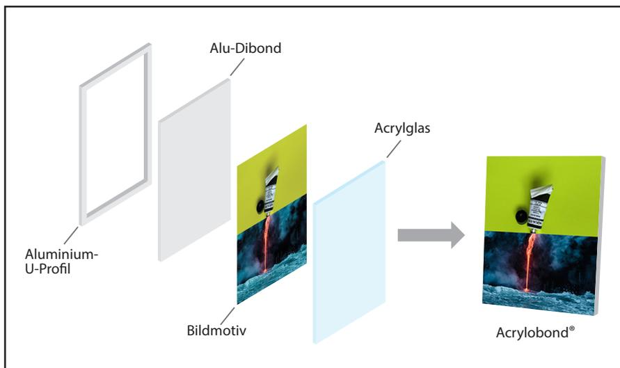
Das Bildmotiv wird per digitaler Daten zunächst auf eine polymere Hochglanzfolie ausgedruckt und auf eine 2 mm starke Aluminium-Verbundplatte kaschirt. Anschließend wird im Sandwich-Verfahren eine 2 mm starke Acrylglasplatte mit dem Ausdruck und der Aluminium-Verbundplatte verklebt.
